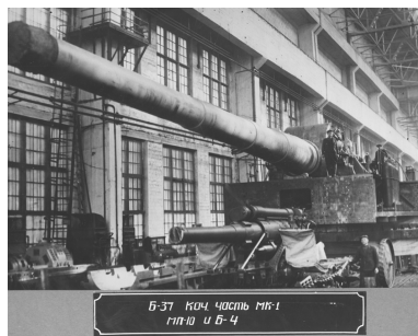
Б-37 Корч. Частей ГПК-1 и ГПК-10 Проверка предельного угла поворота
